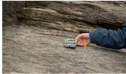
شكل 3-6 قياس اتجاه سطح بواسطة نموذجي بوصلة برنتون و أونيفيرسيل.
