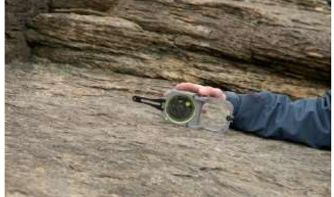
شكل 4-6 قياس ميل سطح بواسطة نموذجي بوصة برنتون و أونيفيرسيل.
