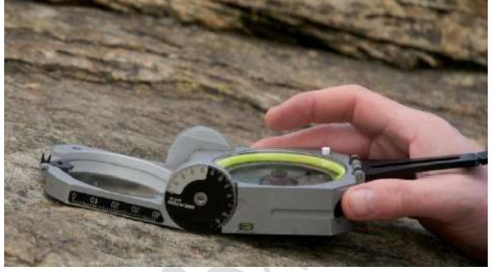
شكل 2-6 قياس سمت ميل سطح بواسطة نموذجي بوصلة برنتون وكلاز.
